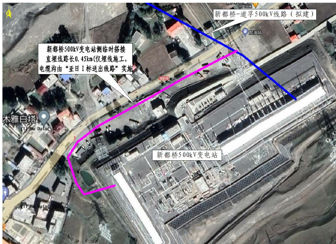
图 2.1-3 新都桥 500kV 变电站侧临时搭接方案示意图（仅埋线施工）
